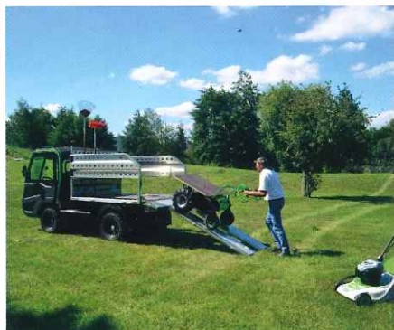
Compuertas laterales convertibles en rampas de carga
